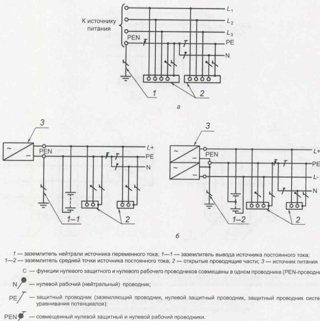
Рисунок 6 — Система TN-C-S переменного (а) и постоянного (б) тока. Нулевой защитный и нулевой рабочий проводники совмещены в одном проводнике в части системы
