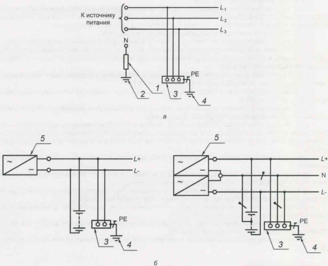
1 — сопротивление заземления нейтрали источника питания (если имеется); 2 — заземлитель; 3 — открытые проводящие части;
